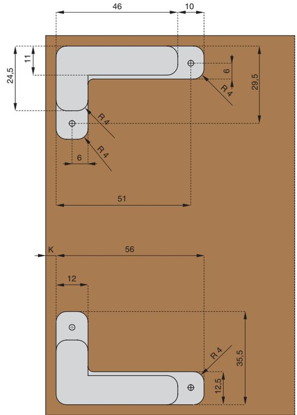
Глубина фрезеровки в каркасе и фасаде
